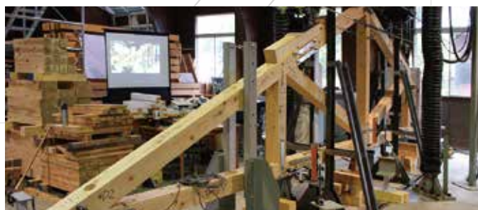
▲南予グループ木造トラス性能検証試験
