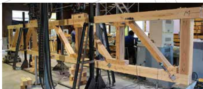
▲東予グループ木造トラス性能検証試験
