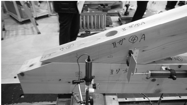
図 2. 合掌尻の上弦材-下弦材仕口のすべり
