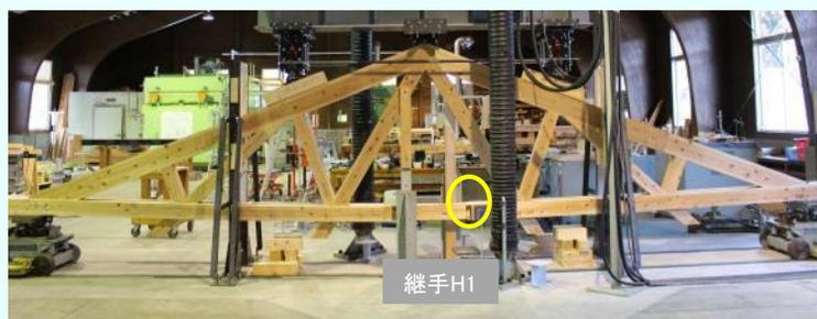
写真-4 破壊後の状況 (○印:破壊した継手)
