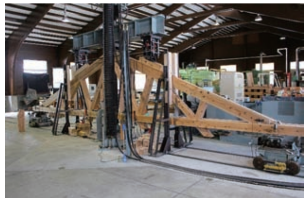
付図3 媛トラスの実験風景
