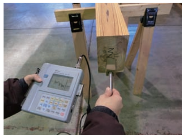
付図4 FFTアナライザーによる動的ヤング係数の計測
