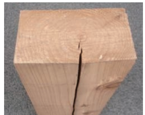
図 5.7 木材の表面割れ
